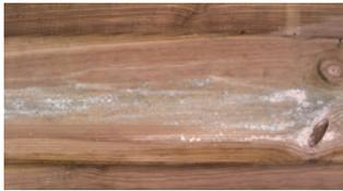
**SALZAUSBLÜHUNGEN:** Vor allem im ersten Jahr nach der Fertigstellung kann es vereinzelt zu Harzaustritten in dieser Form kommen. Durch die Kesseldruckimprägnierung wird das Harz grün-weiß eingefärbt. Dadurch entstehen kleine Flecken auf der Oberfläche. Die Sonne härtet diese Flecken, so dass diese abgeburstet oder abgewischt werden können. Mit der Zeit verwittern sie von allein und stellen keinen Grund zur Beanstandung dar.
