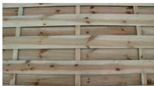
**ÄSTE:** Die Äste und Maserung eines Holzes entsprechen der Charakteristik eines natürlich gewachsenen Rohstoffes. Jedes Stück ein Unikat! Äste unterliegen im Prinzip keinerlei Einschränkungen und können daher in Größe und Anzahl variieren. Insbesondere bei KDI-Produkten sind die Äste nicht immer fest verwachsen und können vereinzelt ausfallen.
