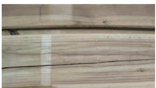
**TROCKENRISSE:** Das Quellen und Schwinden findet im Holz nicht gleichmäßig statt. Dadurch können sogenannte Trockenrisse entstehen. Sie beeinflussen in der Regel nicht die statischen Eigenschaften und die Festigkeit des Holzes und sind daher zu tolerieren.
