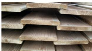
**QUELLEN UND SCHWINDEN:** Durch klimatische Einflüsse nimmt das Holz Feuchtigkeit auf und gibt sie ab. Bei der Aufnahme kommt es zum Quellen des Holzes, bei der Abgabe zum Schwinden. Je nach Holzart fällt dieser Vorgang unterschiedlich aus. Bei Kiefer KDI z. B. kann es in der Stärke und Breite Veränderungen bis zu 8% geben. Berücksichtigen Sie diesen Umstand bei Ihrer Planung und Konstruktion.
