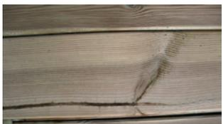
**MARKRÖHRE:** Die Markröhre befindet sich in der Mitte des Baumstammes. Je nach Alter ist sie stark oder weniger stark ausgeprägt. Sie ist zu Lebzeiten des Baumes der Versorgungskanal gewesen. Fälschlicherweise wird sie manchmal als Fäulnis oder Insektenbefall angesehen.
